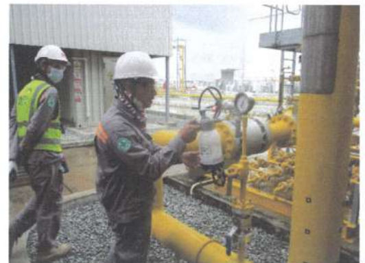
รูปการทดสอบเปรียบเทียบมาตรฐานวัดความดัน
